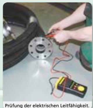
Prüfung der elektrischen Leitfähigkeit.
