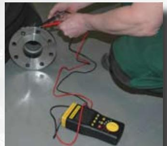
Prüfung der elektrischen Leitfähigkeit.
